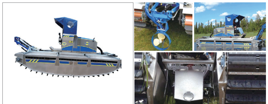
TRUXOR社 수거장치-수륙양용 기술에 무한궤도 형상을 접목하였다. 메인 추진은 유압을 이용한 프로펠러 방식이며 보조 추진으로 무한궤도를 이용한다
