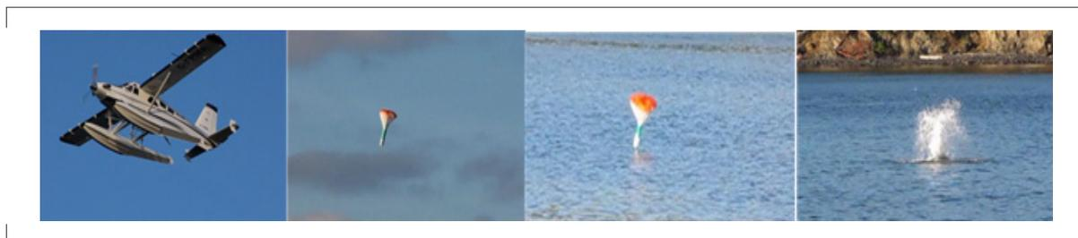
〈그림 2〉 항공기에서 조난현장에 SLDMB를 투하·설치하는 모습
