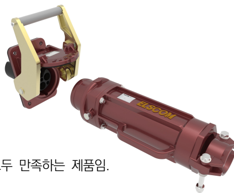
〈그림 5〉 7.2kVac 350A Plug & Socket(엘스콤 제품)
