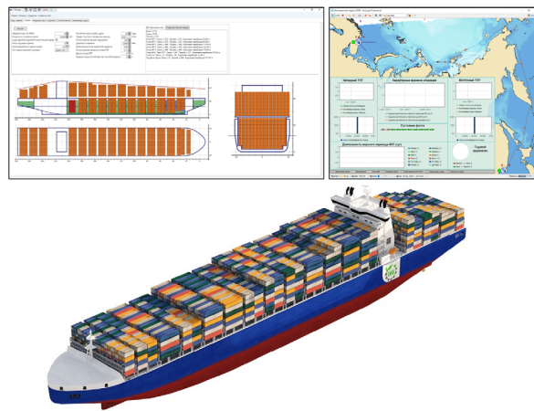
<그림 1> 러시아 CNIMF에서 설계한 쇄빙 컨테이너선 개념도
