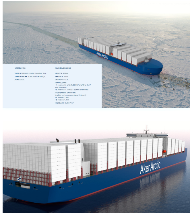
<그림 2> 핀란드 Aker Arctic社에서 설계한 쇄빙컨테이너선 개념도
