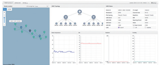
〈그림 2〉 분산형 수중 관측·제어망에서 개발된 수중통신 모듈과 수집 데이터 관리용 어플리케이션
