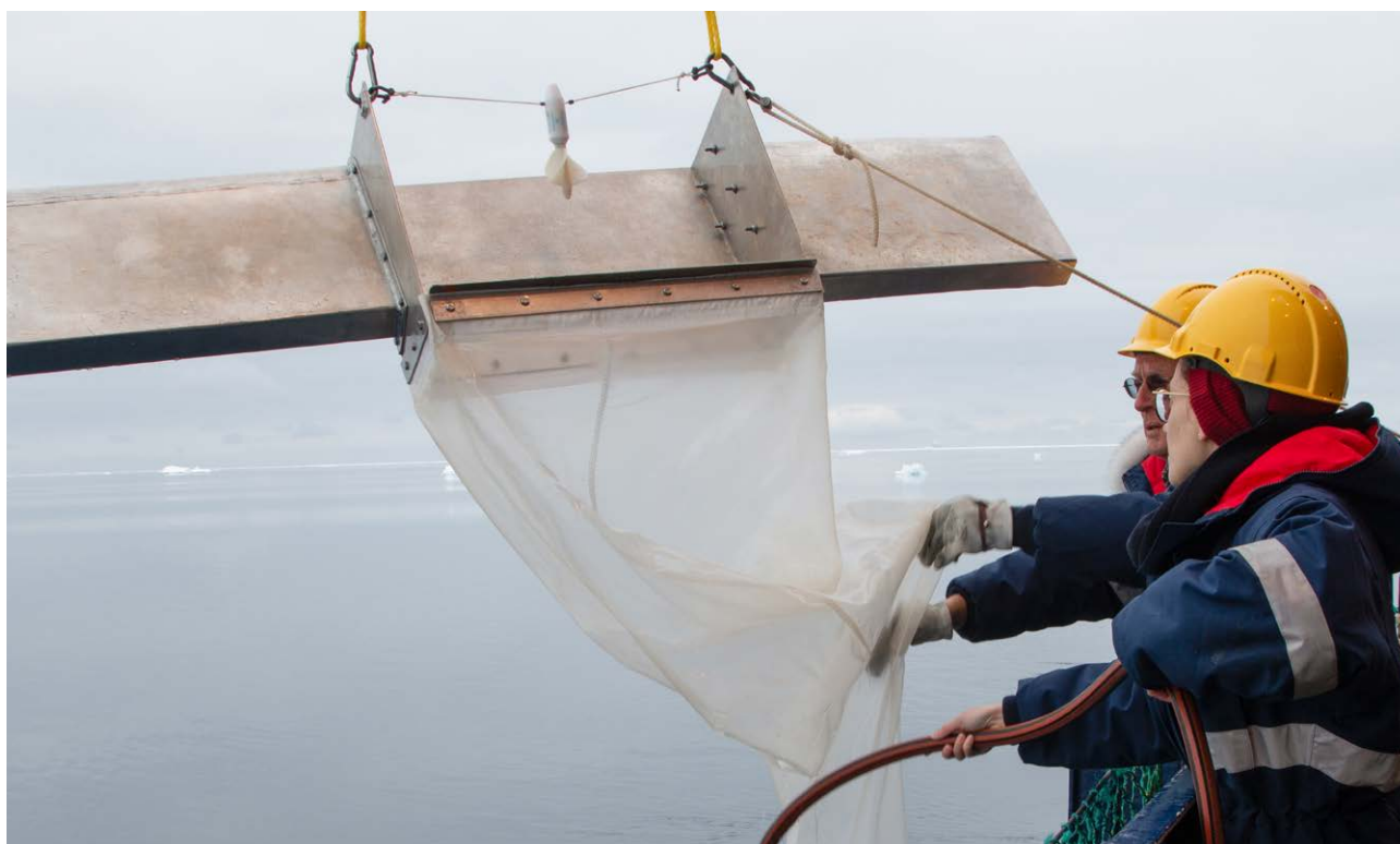
Filet à plancton utilisé pour échantillonner la surface de l'eau dans le cadre d'une étude sur les microplastiques en Antarctique. Photo : Université de Bâle, Patricia Holm
