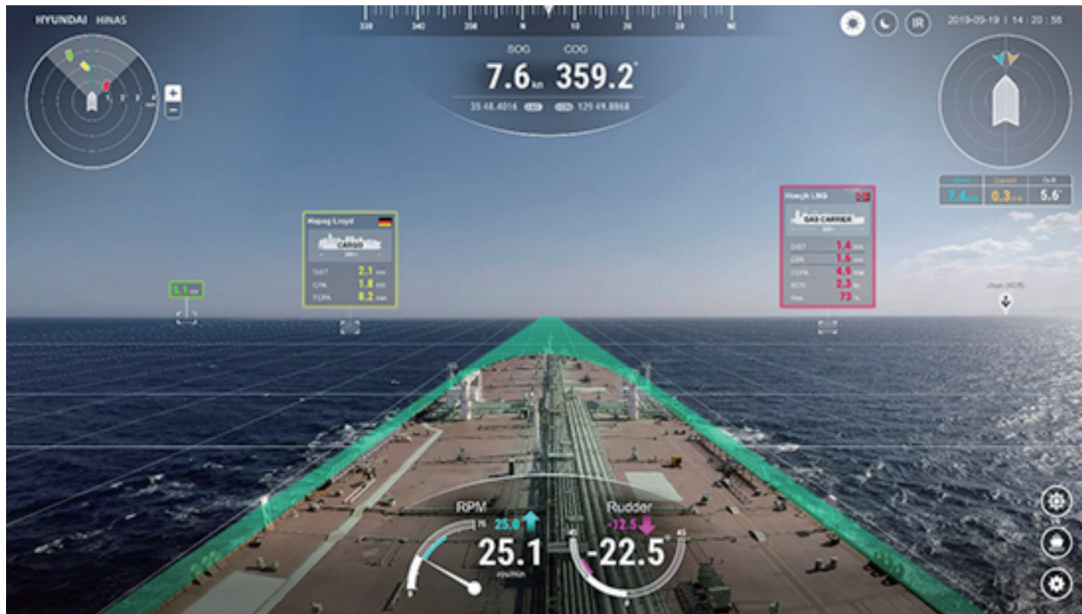
〈그림 4〉 현대중공업에서 개발한 선박 증강현실 시스템
