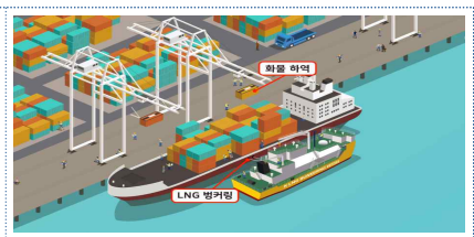
< LNG 병커링 동시작업 >
