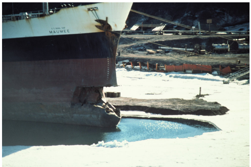
<그림 2> Damage in USNS Maumee caused by ice [3]
